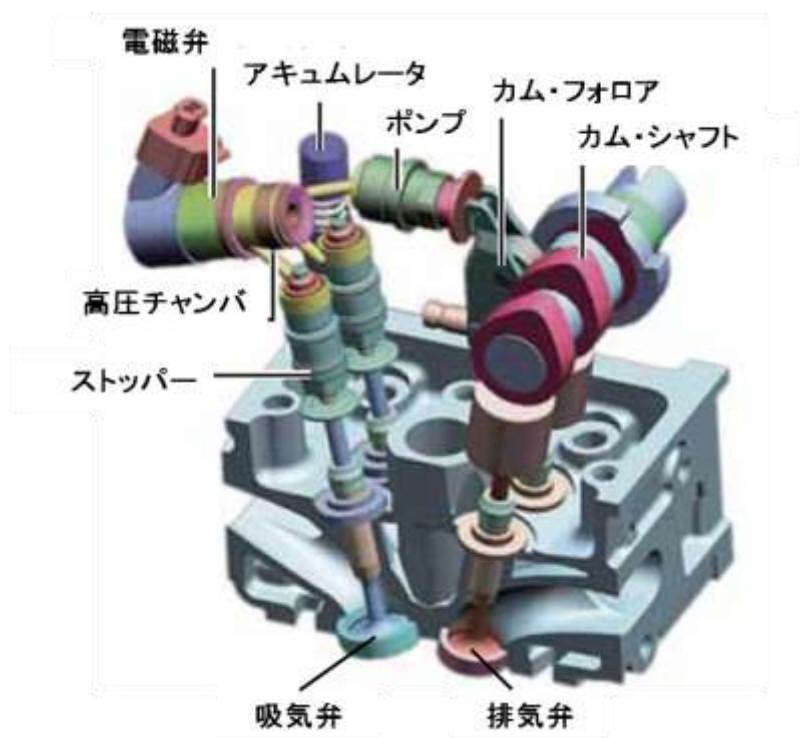
図 5.1 電磁油圧動弁機構[170]
