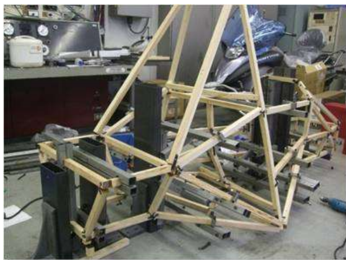
図 3.9 学生が考案した市販 H 型鋼を使った溶接治具
