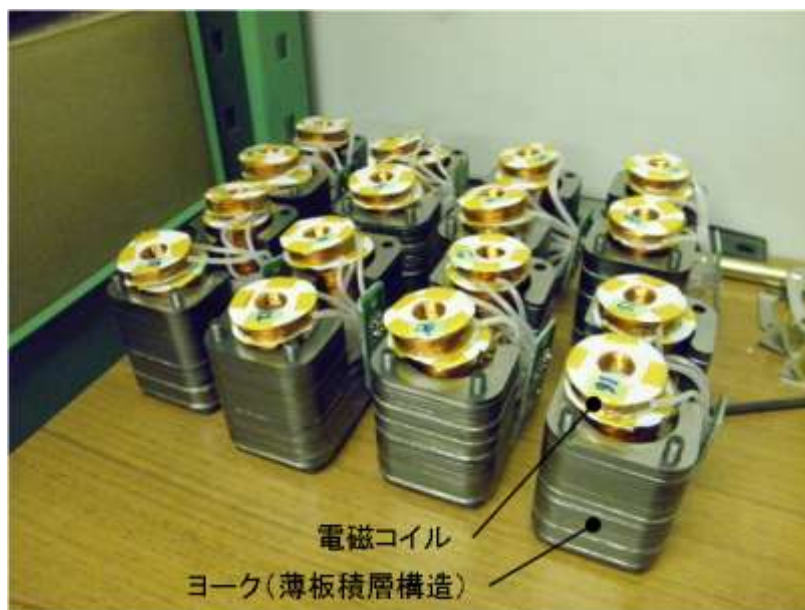
図 5.16 設計・製作した 2 弁式電磁駆動弁機構
