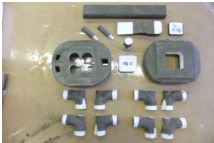
図 5.22 完成した消失模型
