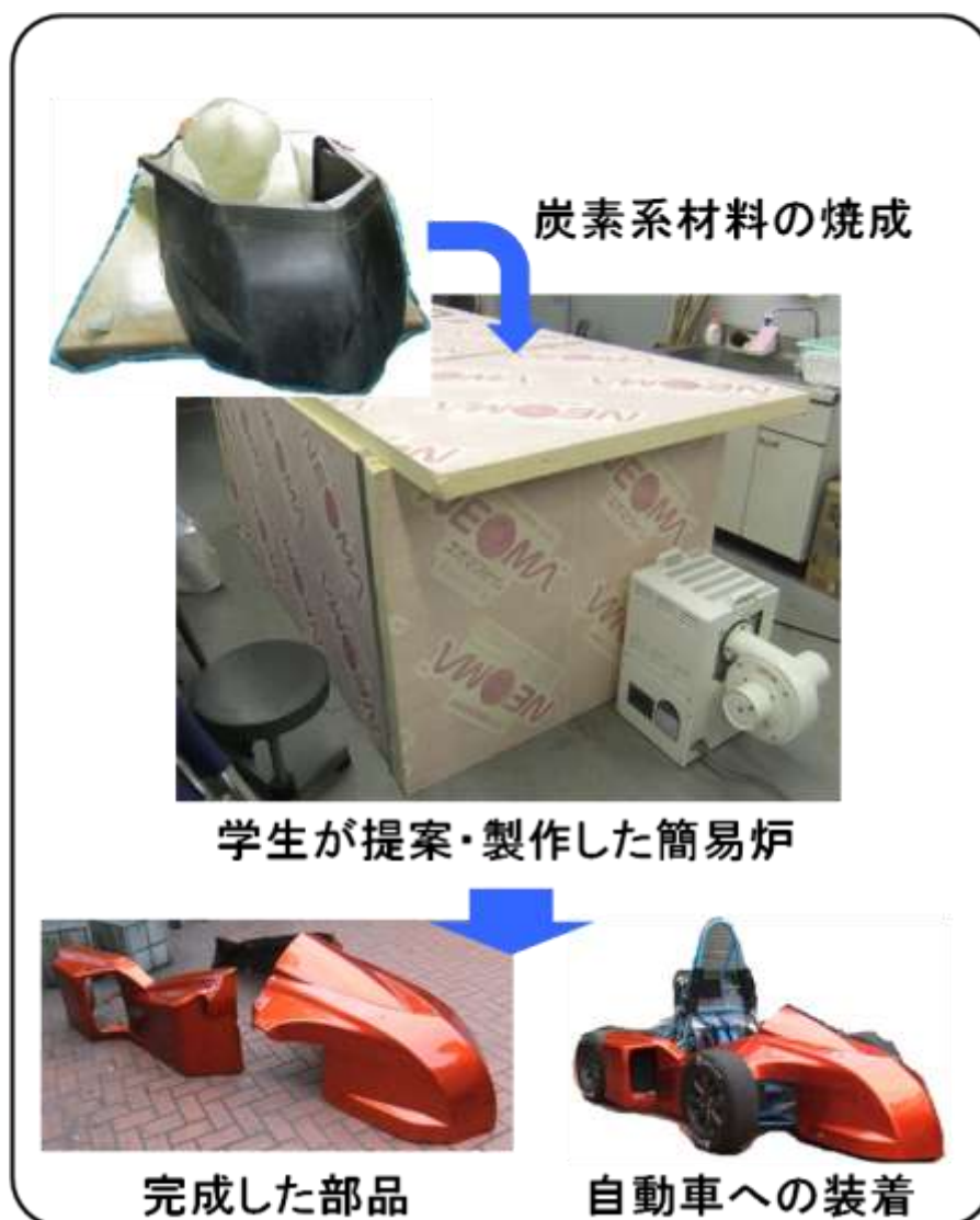
図 4.4 学生が提案した「簡易炉」と製作した部品[151]
