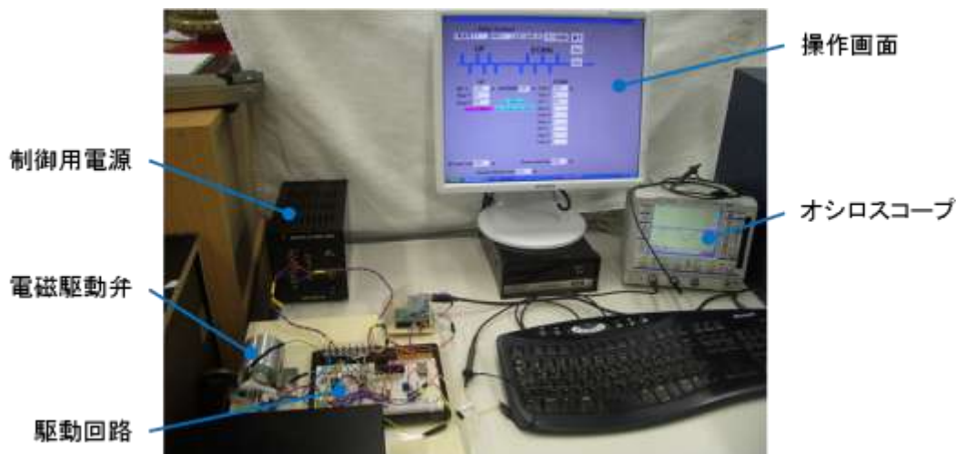
図 5.4 市販の基板台を用いた実験装置
