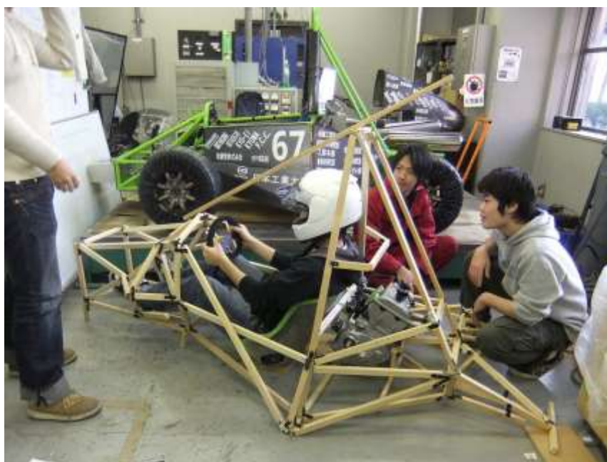
図 3.6 設計検討に用いた木材で製作した車体のモックアップ
