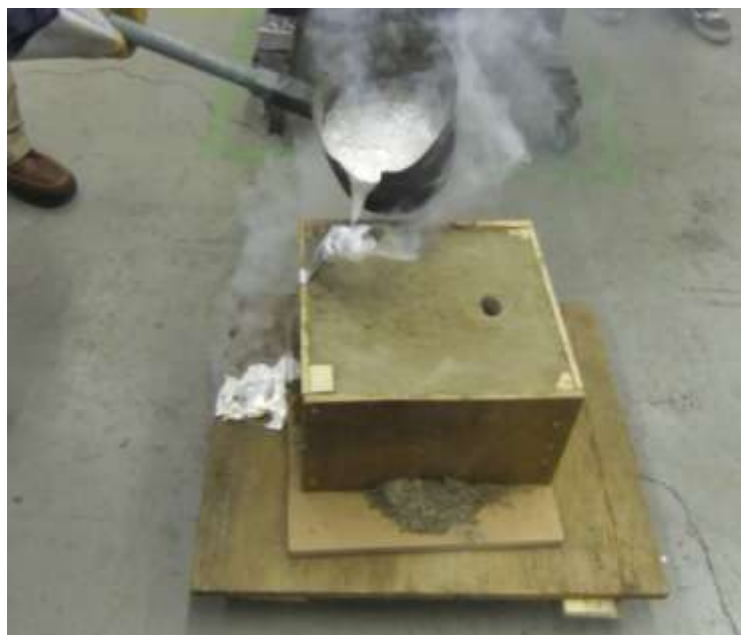
図 5.23 鋳造作業（鋳湯）の様子
