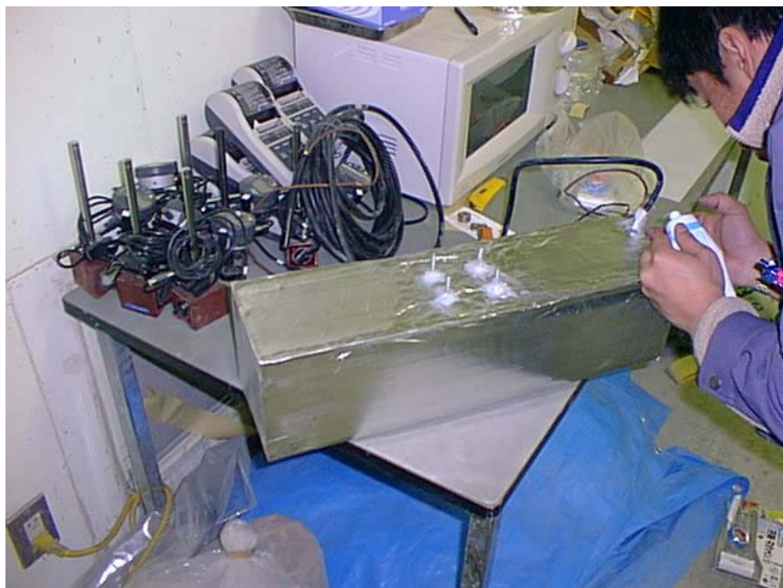
写真-4.7 脱型後における水分の逸散防止のためのアルミ蒸着テープの貼付け（自己収縮試験体）（KYダム）
