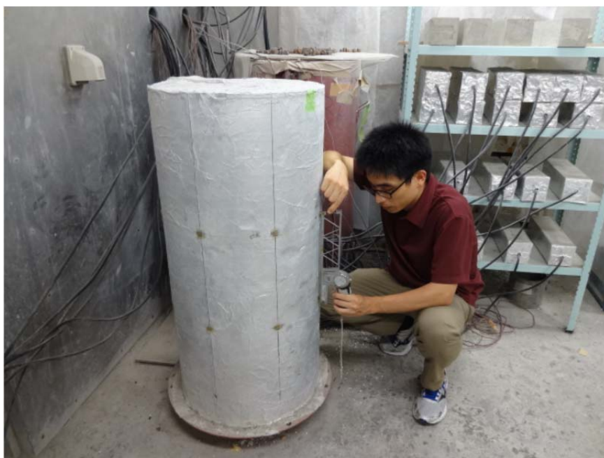
写真-5.9 コンタクトゲージによる鉛直ひずみの測定 11)
