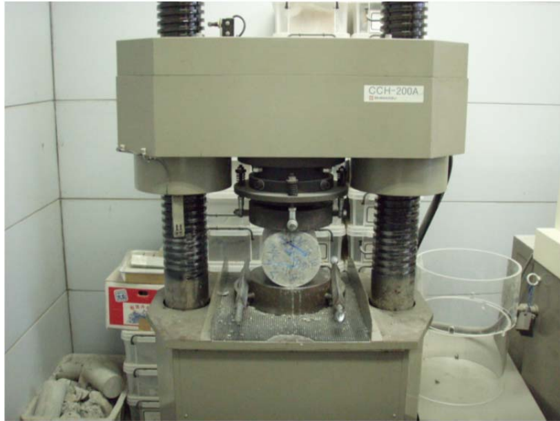
写真-7.3 割裂引張試験の状況
