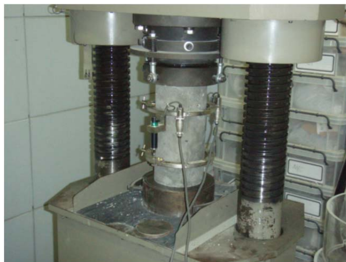
写真-7.2 圧縮試験の状況 (コンプレッソメータを取り付けて静弾性係数を同時に測定)
