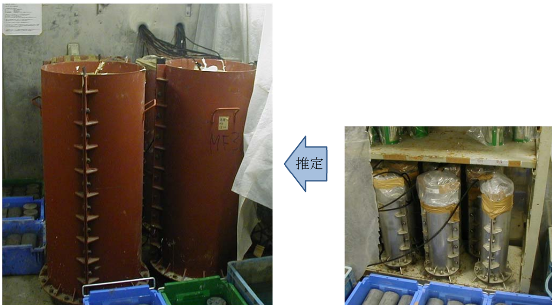
図-6.1 ウェットスクリーニングした小型供試体の試験結果からフルサイズ骨材のダムコンクリートを推定
