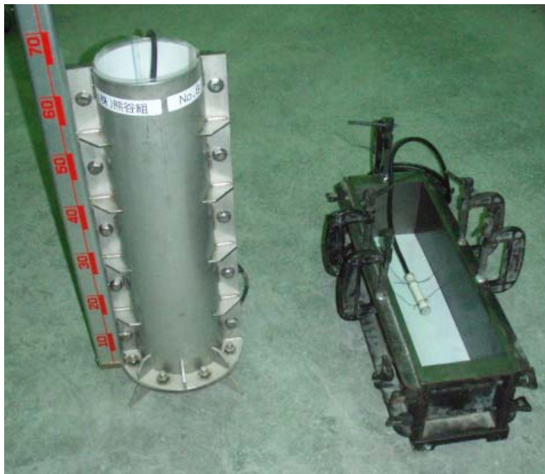
写真-5.4 150×150×530mm の角柱供試体用型枠 と φ150×530mm の円柱供試体用型枠
