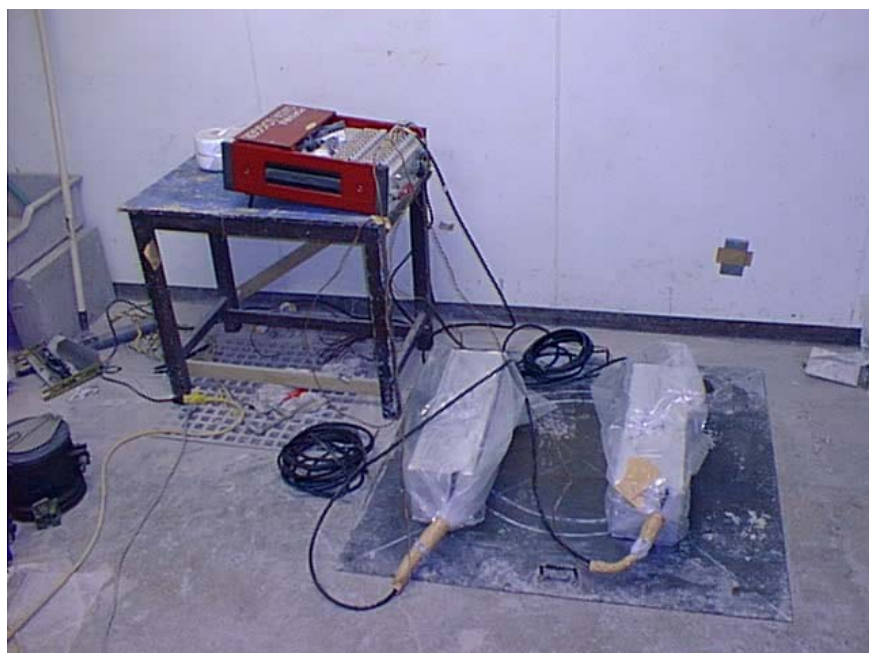
写真-4.8 恒温恒湿養生室における自己収縮ひずみの測定状況 (KY ダム)
