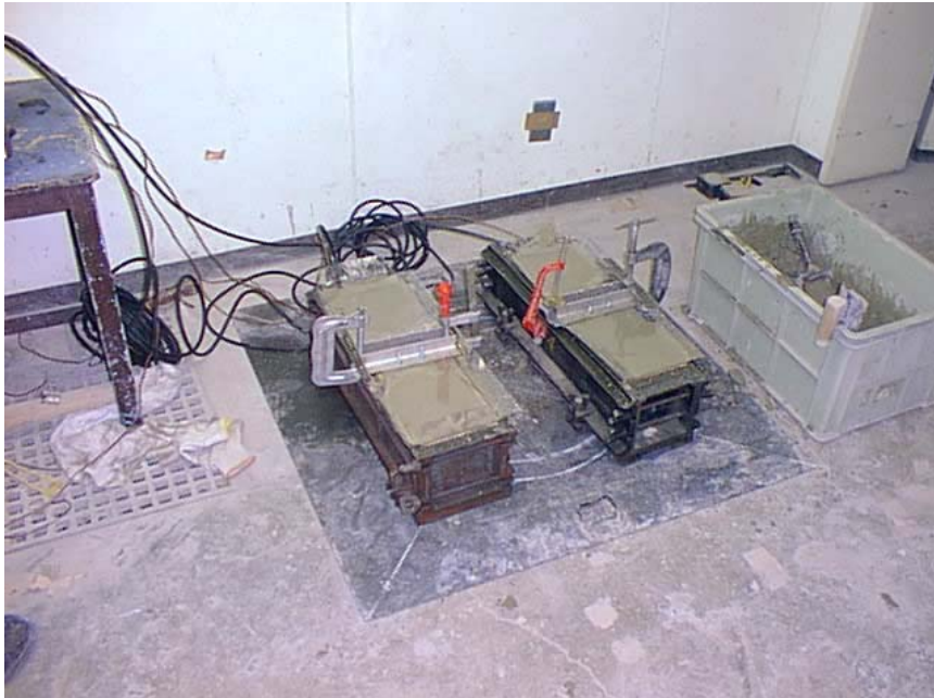
写真-4.6 自己収縮供試体の作成状況（KYダム）
