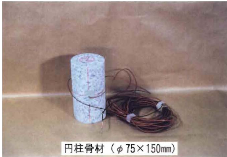
写真-3.4 円柱に成形した骨材 (φ75×150mm)
