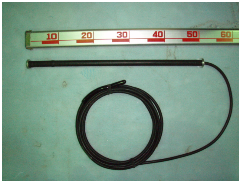
写真-5.7 標点距離 L=500\text{mm} の大型の埋込型ひずみ計（特注品）
