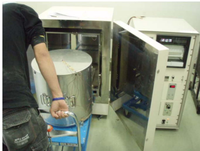
写真-7.1 断熱温度上昇試験の状況
