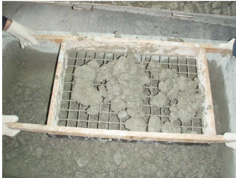
写真-5.6 40mmふるいによるウェットスクリーニング
