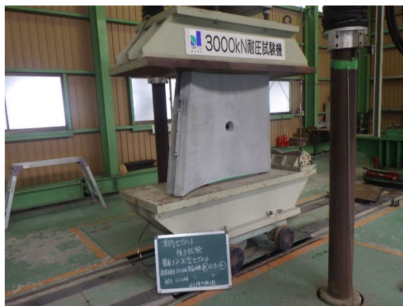
写真 5-9 コンクリートセグメントの推力試験
