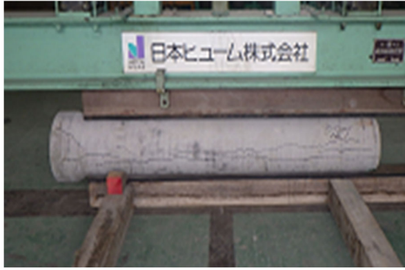
写真 5-4 ヒューム管（開削管）の外圧試験状
