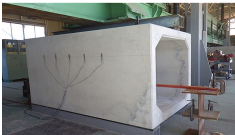
写真5-11 ボックスカルバートの外圧試験状況
