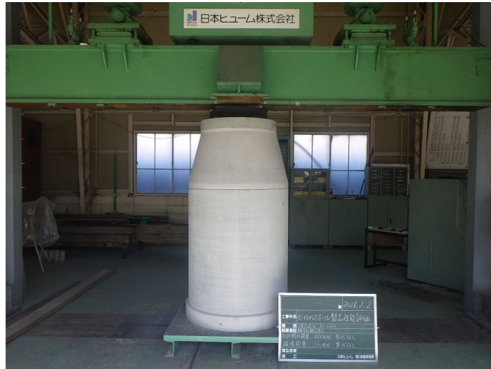
写真 5-3 組立てマンホールの外圧試験状況
