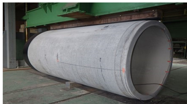
写真 5-5 ヒューム管（推進管）の外圧試験状況
