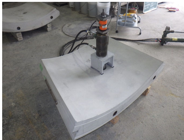
写真 5-10 コンパクトセグメントの吊手金具の引抜き試験
