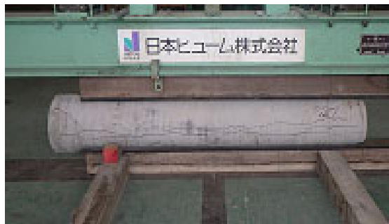
写真 3-2 下水道管の外圧試験
