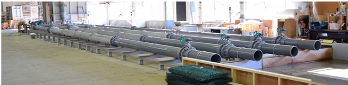
写真 5-12 下水道管水理実験装置
