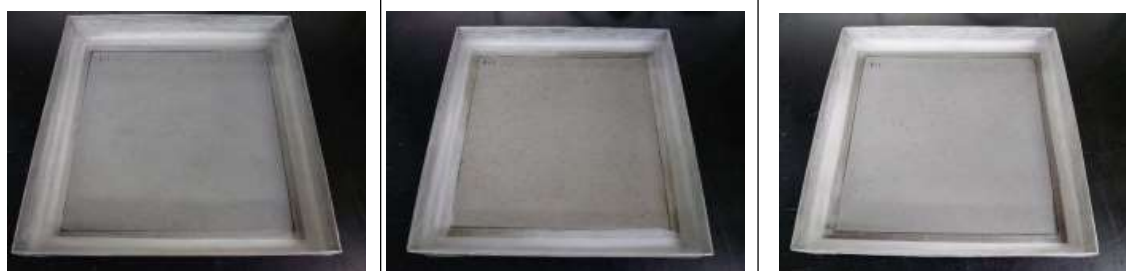
図 2-4-29 透湿率試験状況（左から仕様 FC、WC、CS の基材面）
