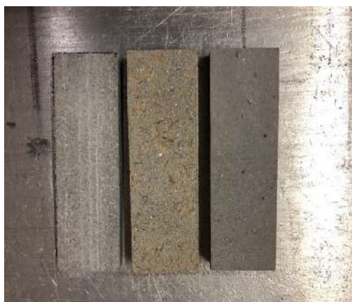
図 2-4-13 各種試料の素地の状態 (左から、仕様 FC、WC、CS)
