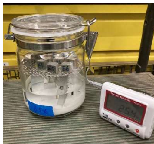
図 2-4-3 容器内への試料の設置
