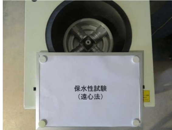
図 2-4-10 容器を遠心法装置に設置した状況
