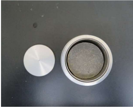
図 2-4-9 試料を遠心法の容器に設置した状態
