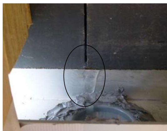
図 2-2-11 仕様D あいじゃくり交点からの流れ出しの状況 (圧力差: 0Pa)
