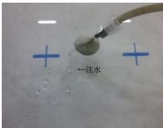
図 3-2-5 注水針による注水状況
