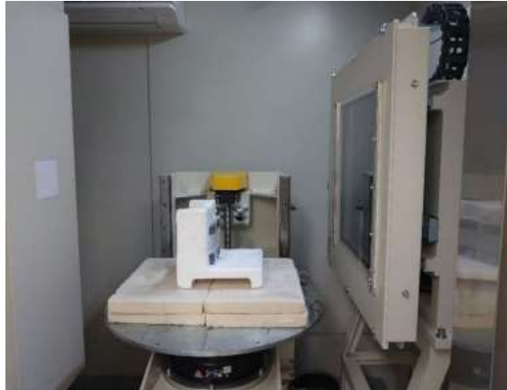
図 2-4-16 X線CTでの透過画像撮影状況
