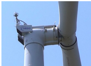
(a) 2 枚ブレードリジッドハブ (Aerodyne 3MW) [2.4]
