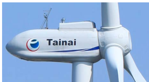
(c) 3 枚ブレードリジッドハブ (SUBARU 2MW)
