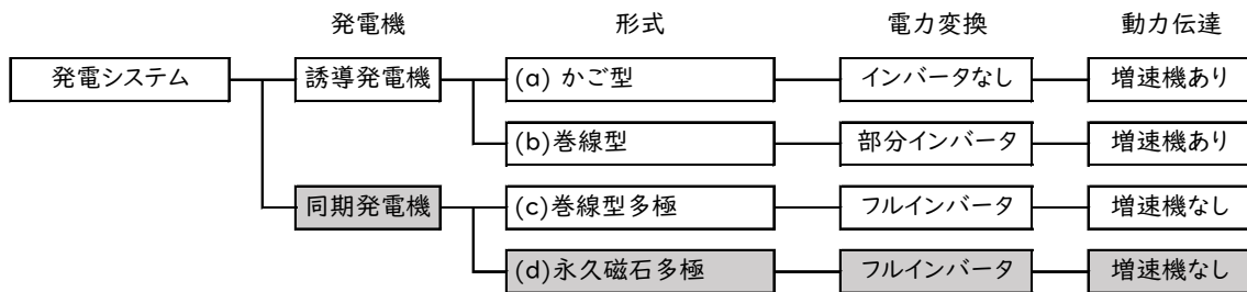
図 4.5 選択した発電機と動力伝達システム
