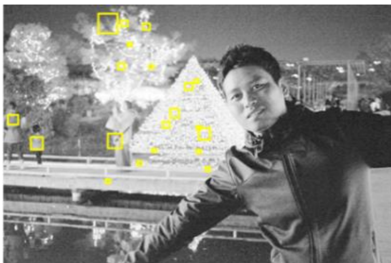
図 3.17 OpenCV(V-J法)での顔検出結果
